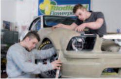
Das BioConcept-Car aus naturfaserverstärktem Material
