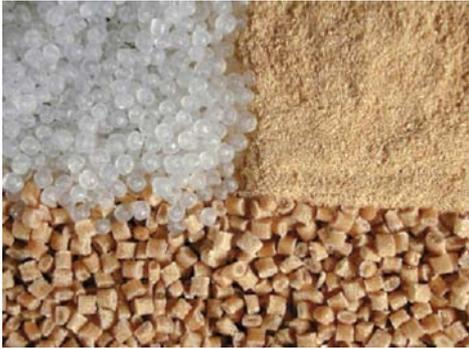
Abbildung 4: Im Uhrzeigersinn: Polyethylengranulat, Holzmehl und WPC-Granulat
